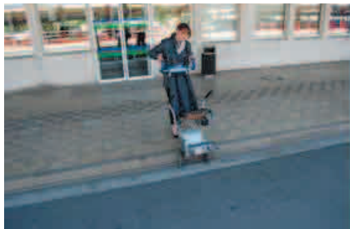
Máquina salva-escaleras en funcionamiento
