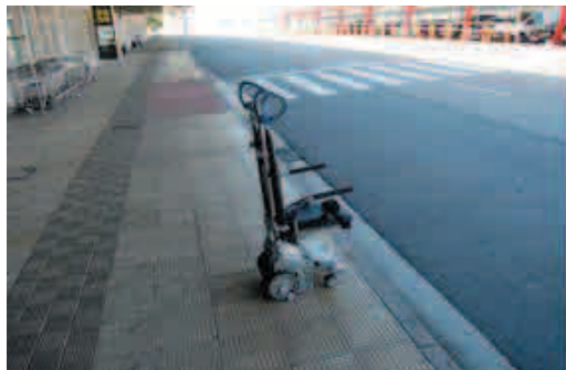
Máquina para el embarque-desembarque de la persona con movilidad reducida
