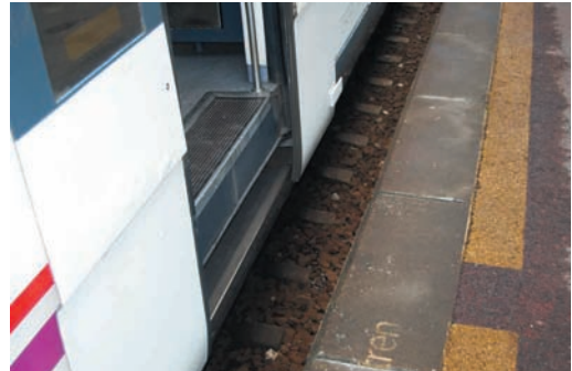
Bereizketako "Gap" horizontala nasaren eta trenaren artean
