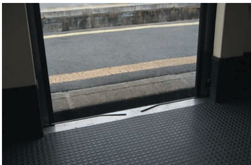
Bereizketako "Gap" aldagarria nasaren eta trenaren artean
