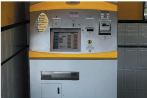
Autosalmentako makinen modeloa. Irakurketaren plano bisuala eta ordainketa egiteko zirikituak altuegi (>1,20 m)
