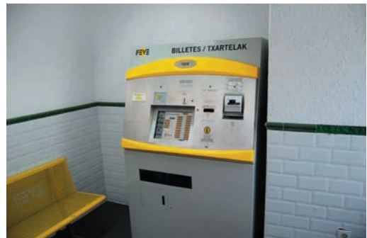
Autosalmentako makinen modeloa. Irakurketaren plano bisuala eta ordainketa egiteko zirikituak altuegi (>1,20 m)
