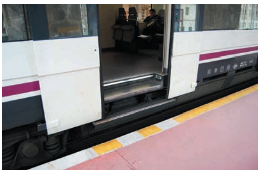
Bereizketa bertikal-horizontal handia nasaren eta trenaren artean
