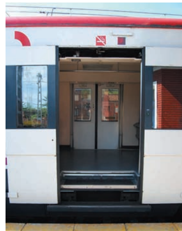
Bereizketako "Gap" bertikala nasaren eta trenaren artean
