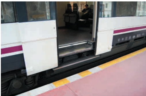
Gran separación vertical-horizontal andén-tren
