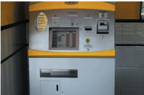
Modelo de máquina autoventa. Plano visual de lectura y dispositivos de pago a excesiva altura (>1,20 m)
