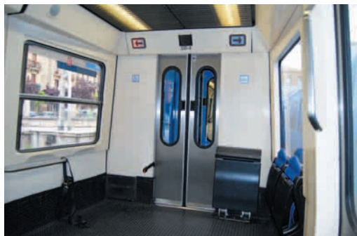
Vagón para personas con movilidad reducida. Espacio habilitado para silla de ruedas
