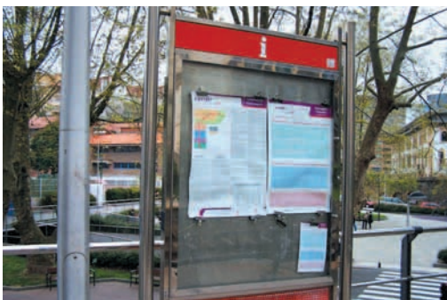
Panel estático en plano visual de lectura inadecuado y con caracteres pequeños
