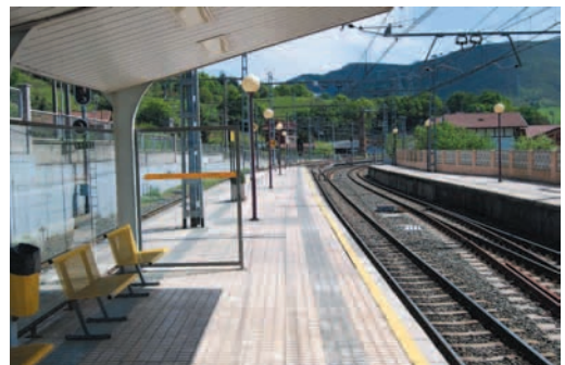
Banda cromática sin pavimento de botones
