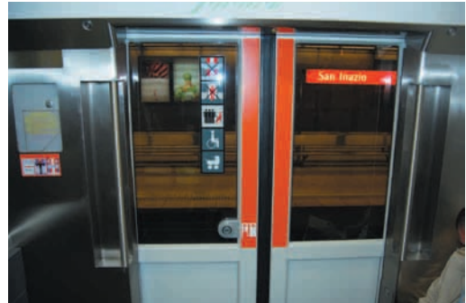
Puerta de acceso para personas con movilidad reducida
