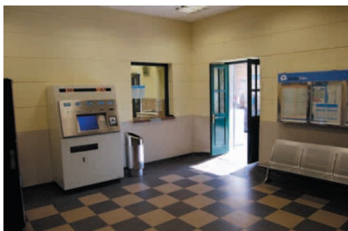
Complicado acercamiento al panel por la disposición del mobiliario presente. Plano visual de lectura demasiado elevado
